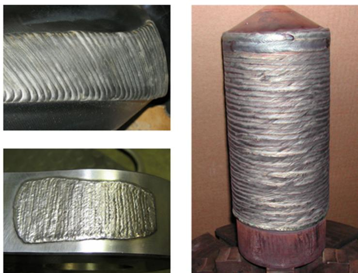
Figura 4.2 – Exemplos de camadas de revestimento depositadas a partir de processos de soldagem
