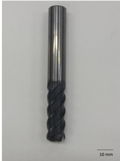
Figura 4.2. Fresa Coromill Plura código ISO/ANSI R215.H4-10050DAC0P 1620 da Sandvik®
