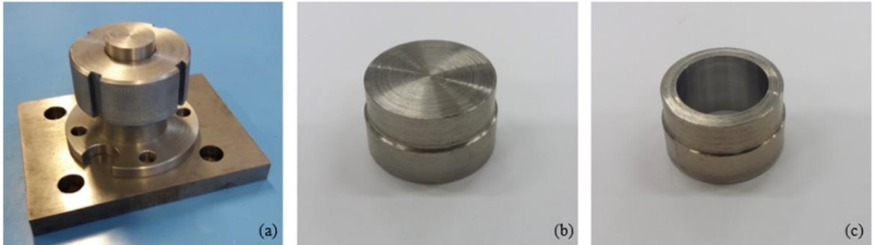
Figura 4.3. (a) Dispositivo de fixação montado com o corpo de prova; (b) corpo de prova e (c) corpo de prova usinado do aço inoxidável super duplex UNS S32760
