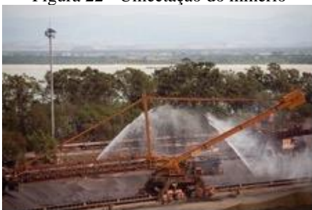
Figura 22 - Umectação do minério
