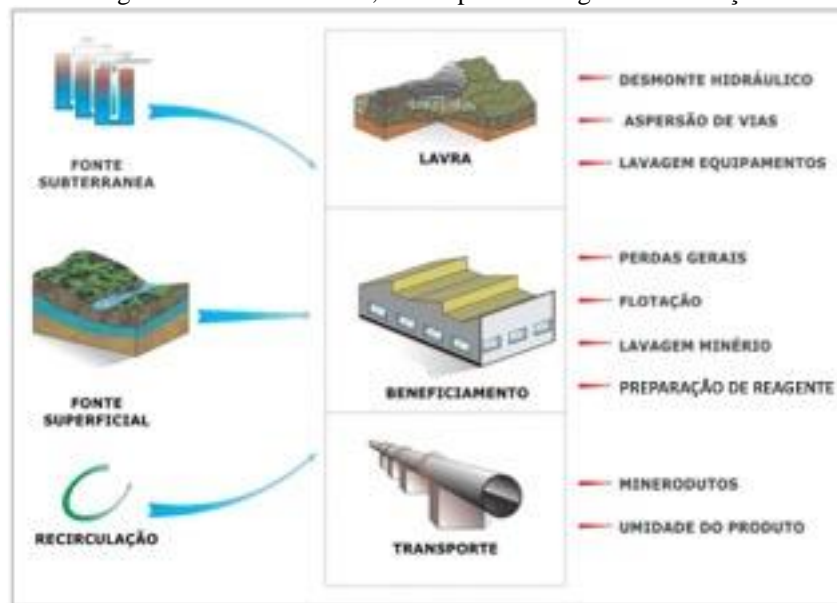
Figura 3- Possíveis fontes, usos e perdas de água na mineração
