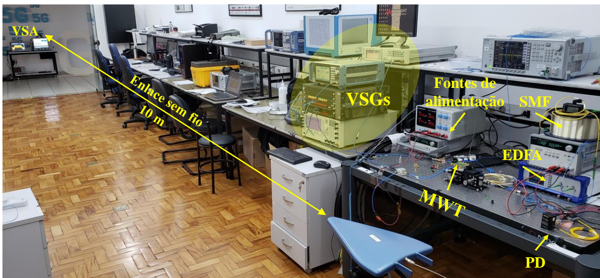
Figura 35 – Fotografia da implementação em ambiente interno do sistema FiWi 5G NR NSA.
