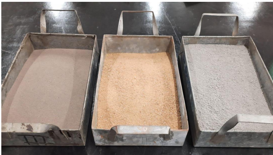
Figura 9 – RMF, Areia Média e CPV-ARI para composição dos traços das argamassas
