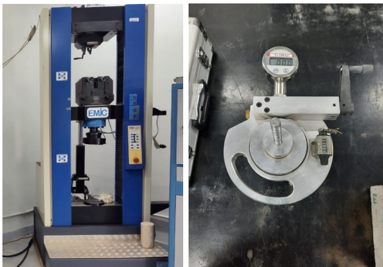
Figura 10 – Instrumentos de Medição EMIC DL 20000 (a) e dinamômetro hidráulico (b)
