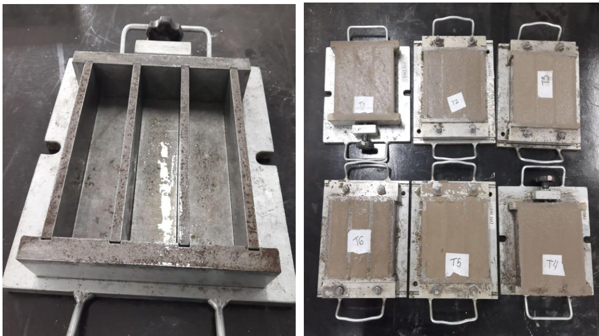
Figura 12 - Moldagem dos corpos de prova para os ensaios mecânicos
