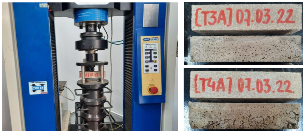
Figura 16 - Teste de resistência à tração na flexão
