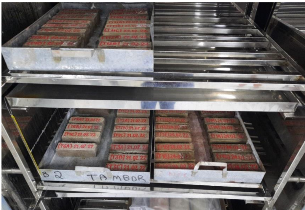
Figura 13 – Processo de cura dos corpos de prova em câmara climática
