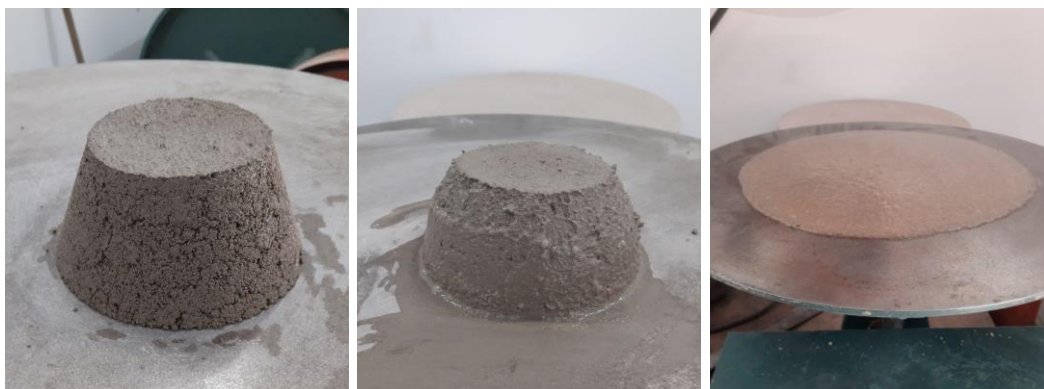
Figura 11 - Ensaio de Índice de Consistência das argamassas com três traços distintos
