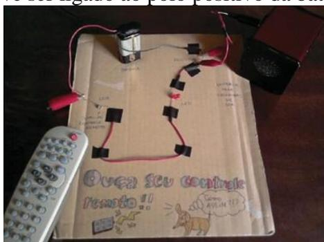
Figura 2. Circuito montado do experimento “Ouça seu controle remoto!”. Fonte: Silva e Assis (2012)
