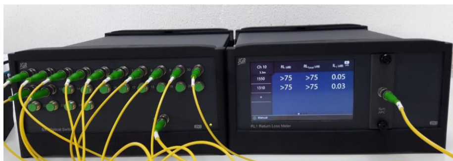
Figura 3.13 - Equipamento de Medição de PI e PR, JGR Modelo RL1. Fonte: Arquivo do LTET-Unifei.
