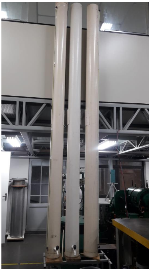
Figura 3.10 - Dispositivo para a realização do ensaio imersão em água. Fonte: Arquivo do LTET-Unifei.
