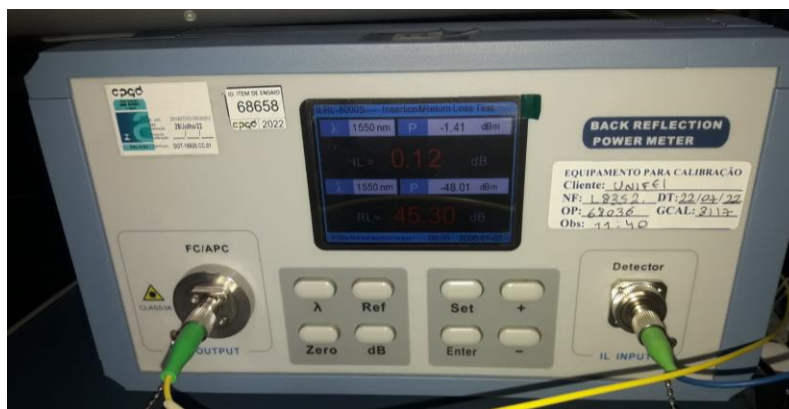
Figura 3.12 - Equipamento de medição de PI e PR, NKLT Modelo SGX 501. Fonte: Arquivo do LTET-Unifei.
