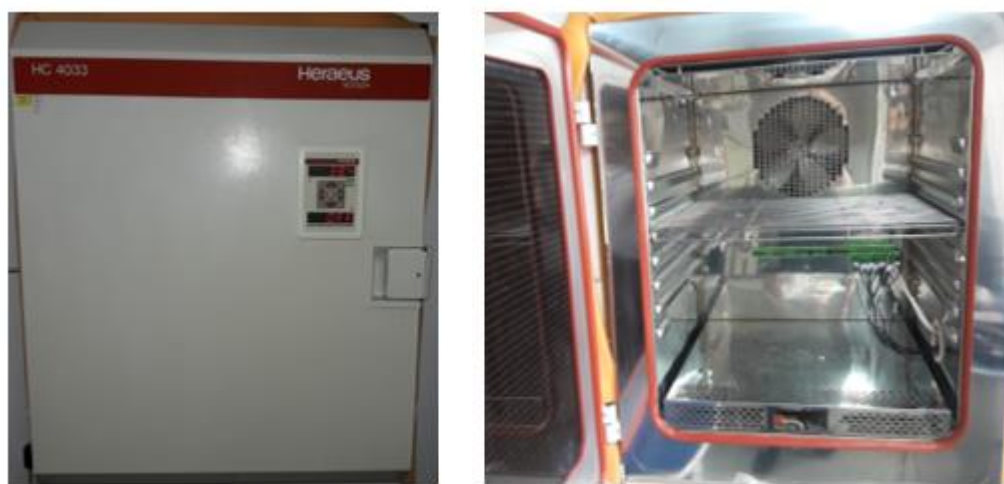
Figura 3.8 - Camara Climática Heraeus HC 4033. Fonte: Arquivo do LTET-Unifei.
