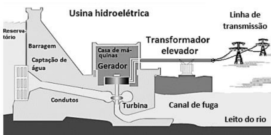
Figura 4 – Principais componentes para geração hidrelétrica. Fonte: adaptado de Moura (2019).
