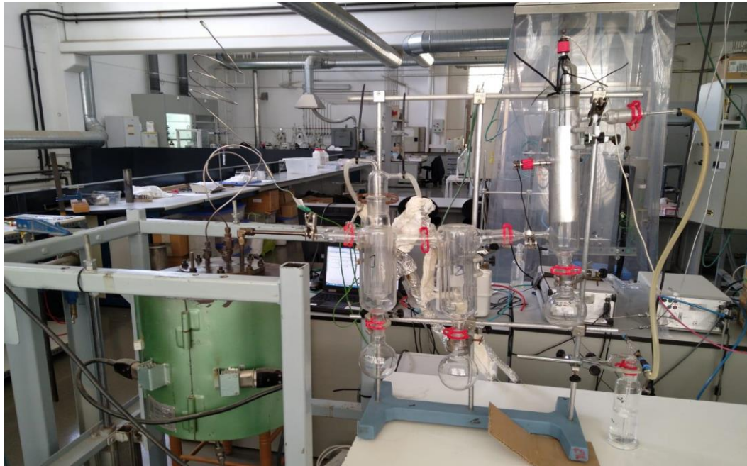
Figura 27 - Disposição dos equipamentos para pirólise de leito fixo
