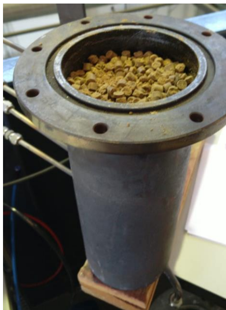
Figura 25 - Reator de leito fixo alimentado com a FCO
