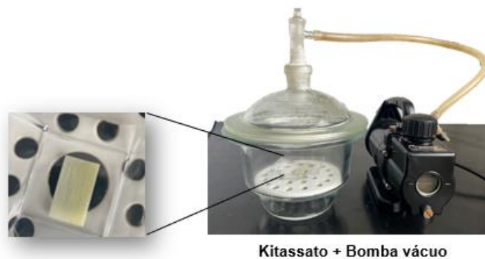
Figura 15– Ilustração do sistema usado na elaboração da de amostras de Madeira Transparente
