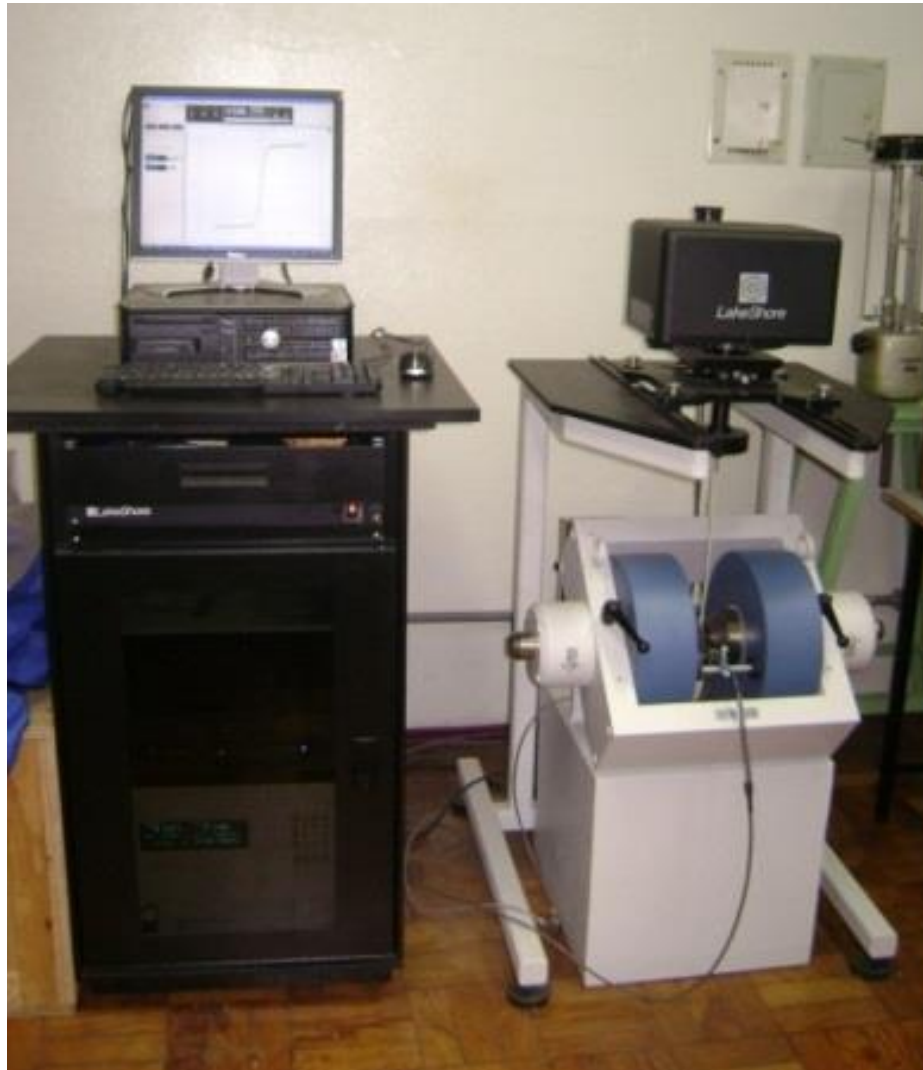
Figura 3-15- Magnetômetro de Amostra Vibrante composto por um ordenador, uma fonte de corrente, um eletroímã, um sensor de campo magnético e um sistema para movimentação da amostra.
