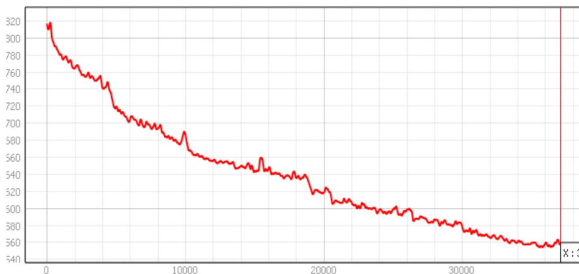
Figura 9 - Perfil Longitudinal do trecho do rio Caratinga-área de estudo.
