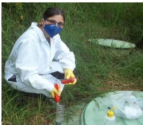
Figura 16 – Medição da concentração de H 2 S do reator UASB
