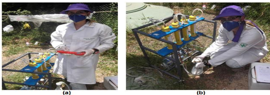
Figura 24 – (a) Análise do gás com detector. (b) Preparo da coleta do gás com solução.
