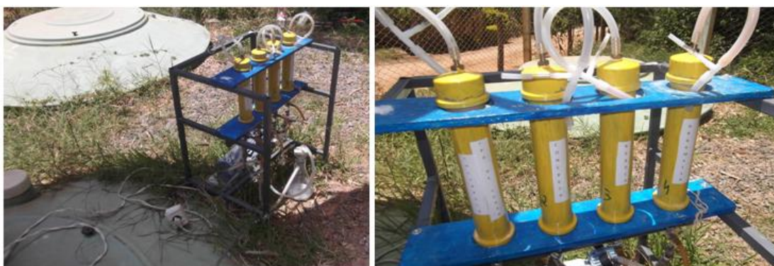
(a) (b) Figura 20 – (a) Aparato experimental ao lado do reator UASB (b) Filtros.
