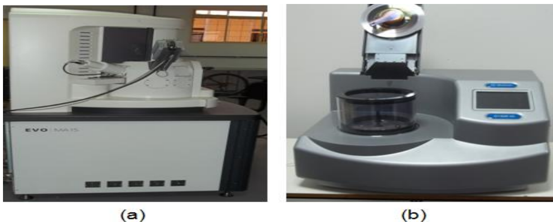
Figura 18 – (a) MEV; (b) Metalizador
