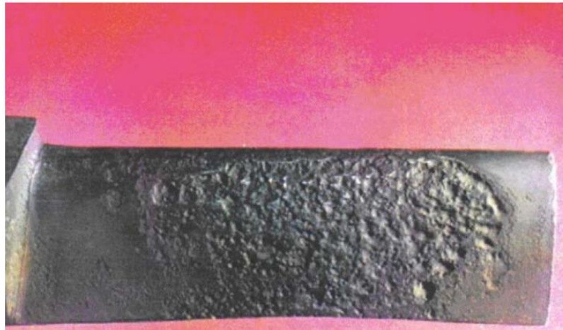
Figura 2.18. Corrosão de uma palheta (Fonte: Monteiro, 2010)
