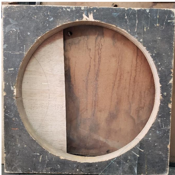
Figura 11 - Molde para a confecção do corpo dos tambores.
