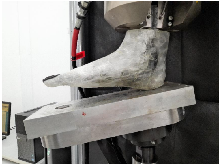
Figura 3.24 – Posição de ensaio calcanhar. Fonte: Autor
