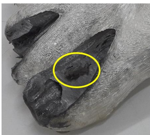
Figura 4.18 – Regiões com falta de resina
