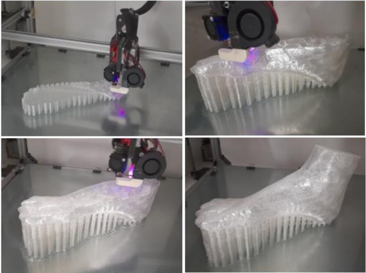
Figura 3.17 – Processo de impressão 3D do modelo final. Fonte: Autor
