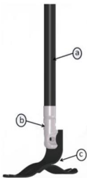
Figura 2.5 - Prótese modular para amputações de membros inferiores: a) Tubo protético, b) Suporte, c) Pé protético. Fonte: Autor.
