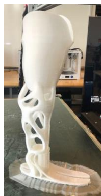
Figura 2.14 – Prótese monocoque personalizada. Fonte: Adaptado de (Nicoloso, L.G.V. et al , 2021)
