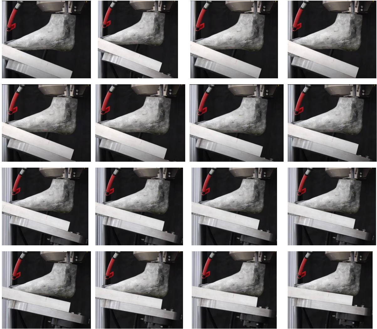
Figura 4.5 - Ensaio de Compressão no Antepé
