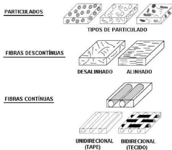
Figura 2.6 - Disposição dos tipos de reforço. Fonte: Adaptado de (KAW, 2006)
