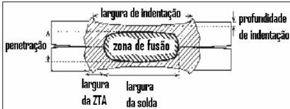
Figura 2.19 - Geometria do ponto de solda. Fonte: Zhou et al. (2003).
