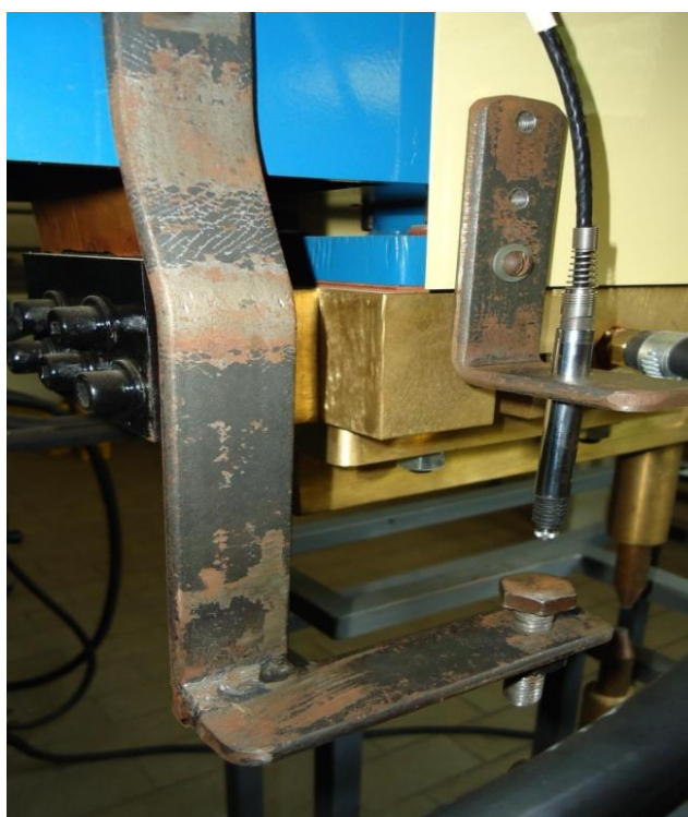
Figura 3.3 - Acoplamento do sensor LVDT ao cabeçote móvel.
