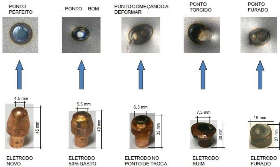
Figura 2.15 - Desgaste do eletrodo. Adaptado de: Usiminas (2010).
