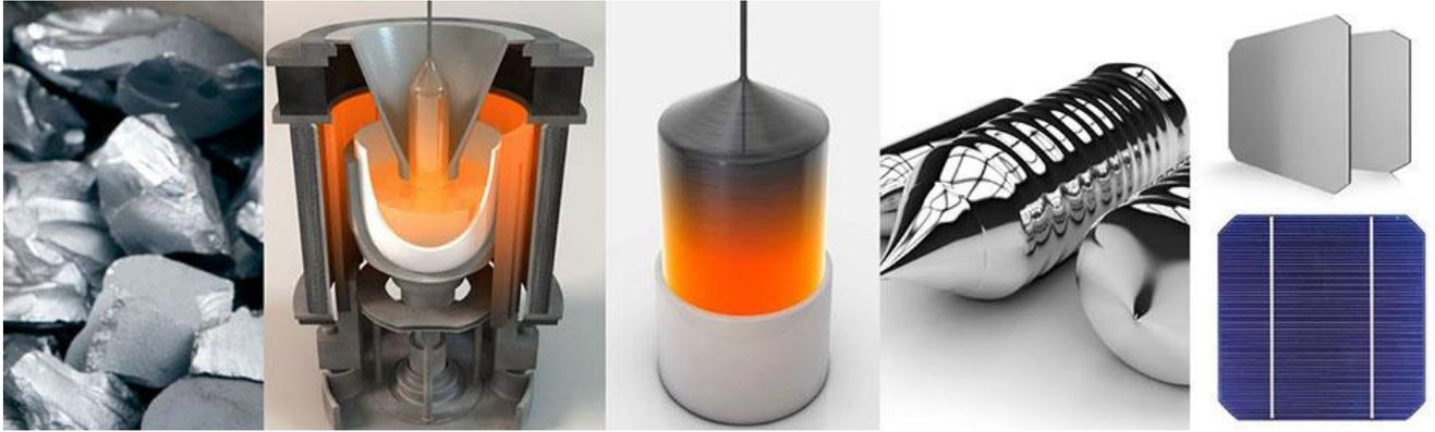
**Figura 15 - Processo de fabricação da célula de silício monocristalino**
