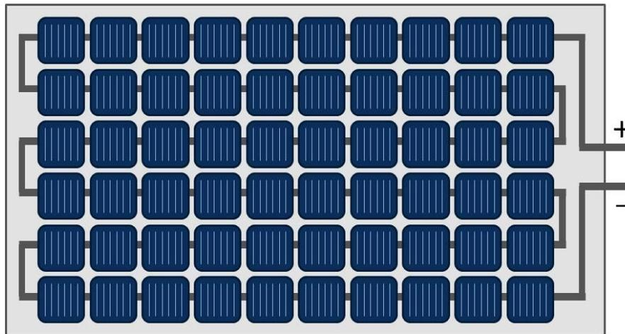
**Figura 20 - Conexão em série das células fotovoltaicas no Painel**
