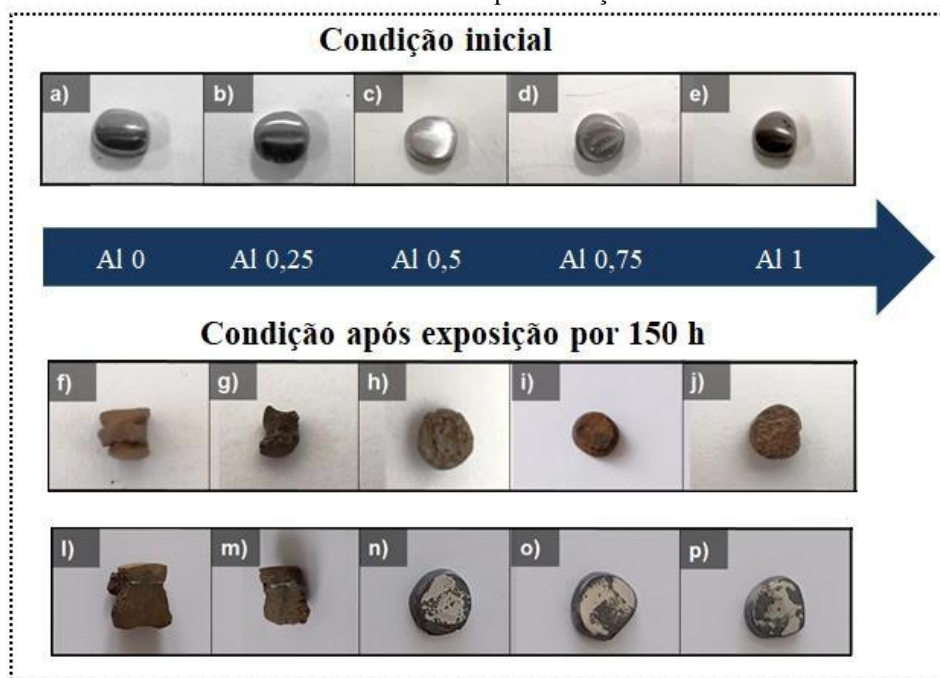
Figura 45-Morfologia macroscópica da superfície de Al 0, Al 0,25, Al 0,5, Al 0,75 e Al 1 durante antes e após oxidação à 800 °C.
