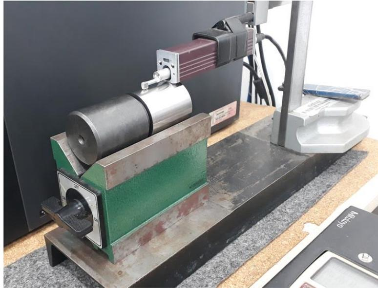
Figura 4.7 – Montagem do rugosímetro para realização das medições de  $R_a$
