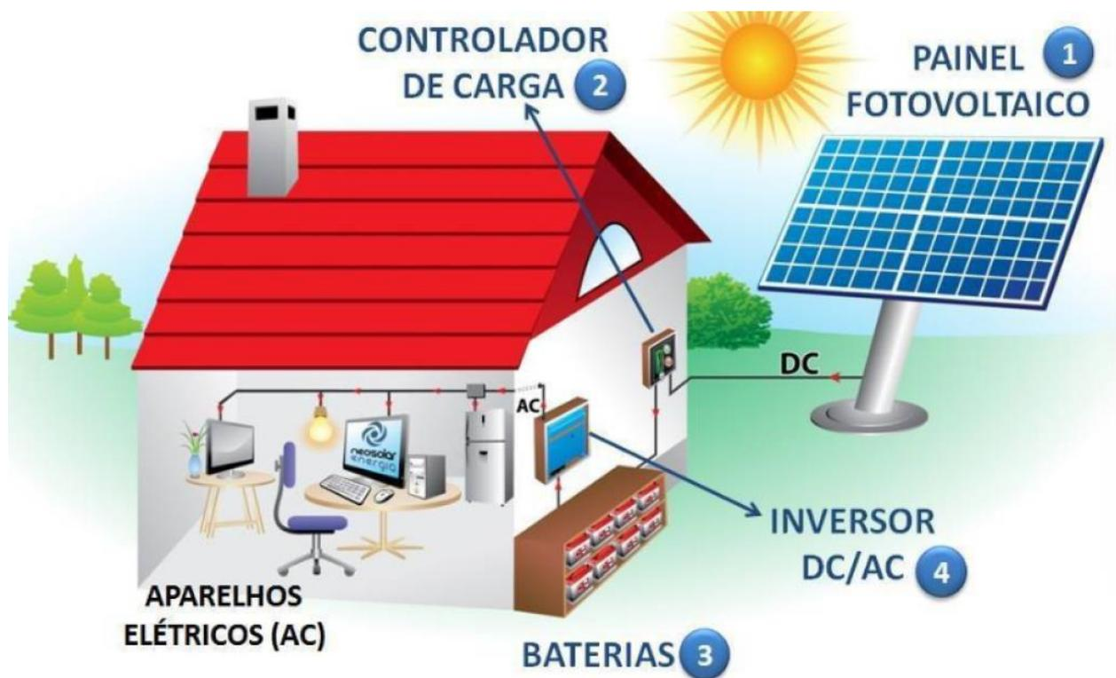
Figura 7: Sistema off-grid [8].
