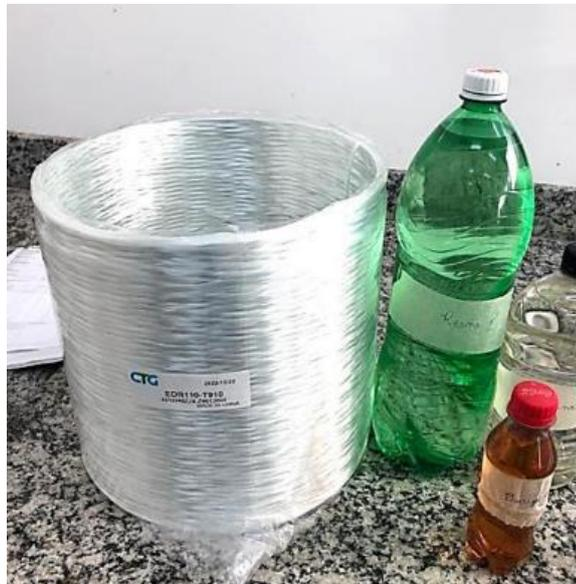
Figura 13 – *Roving* e resinas.
