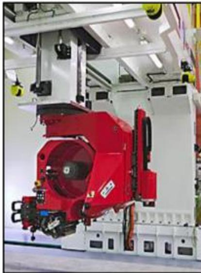
Figura 4 – Máquina de Laminação Automática da SAAB(ROBERTS, 2006).
