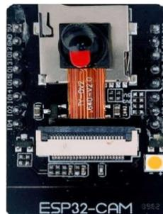
Figura 12 – Dispositivo principal de captura de imagens, figura do autor.
