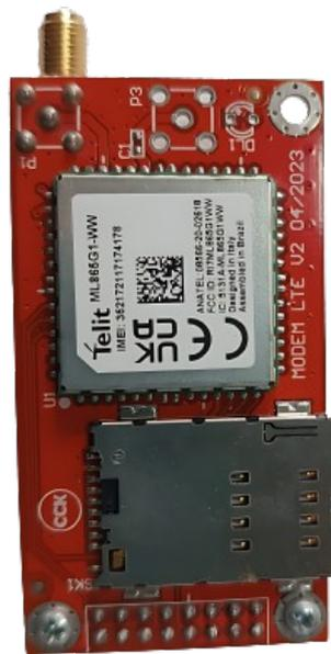
Figura 17 – MODEM NB-IoT, figura do autor.
