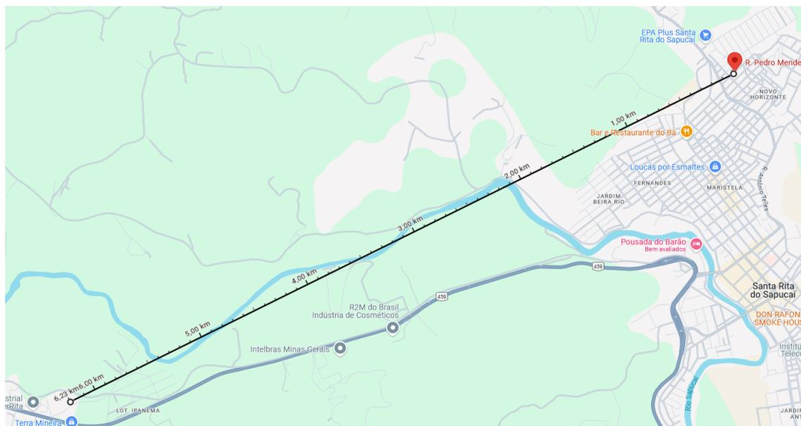
Figura 42 – Distância dos dados transmitidos com tecnologia LoRa, figura do autor
