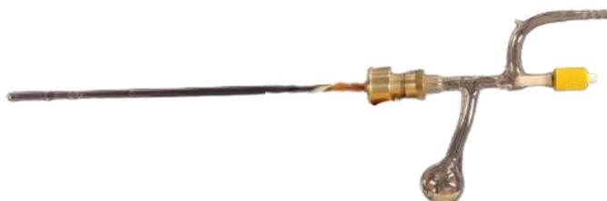
Figura 34: Cubeta que permite a remoção do oxigênio para medida em solução.
