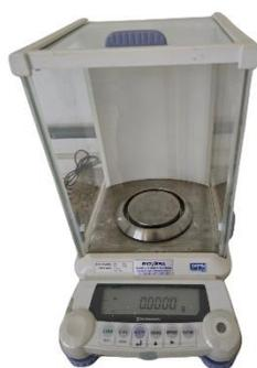
Figura 27: Balança analítica, utilizado para pesagem das amostras.
