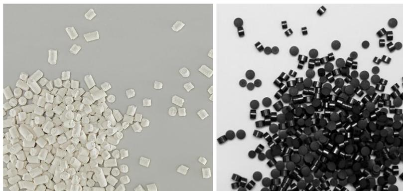
Figura 15 – Exemplos de adsorventes Actisorb S2 (esquerda) Actisorb S6 (direita).
