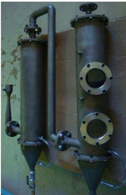
Figura 27 – Lavadores à água: Venturi (à esquerda) + torre de nebulização (à direita).
