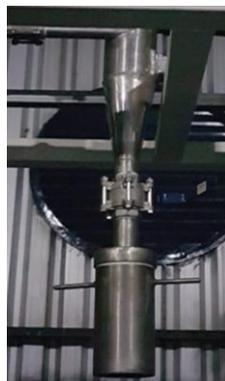
Figura 21 – Ciclone atualmente integrado ao gaseificador de leito fluidizado.
