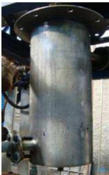
Figura 29 – Reator a ser utilizado como filtro de segurança.
