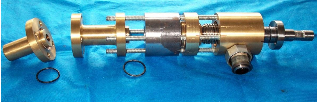
Figura 3-18 – Válvula ciclônica de escoamento reverso de segunda geração construída.
