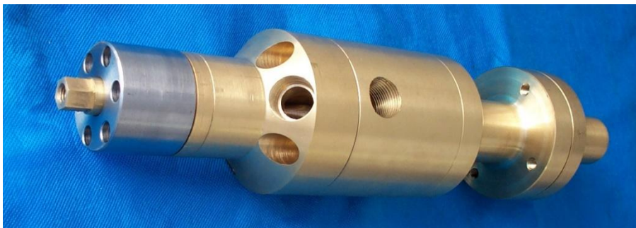
Figura 3-6– Válvula ciclônica de escoamento reverso montada.
