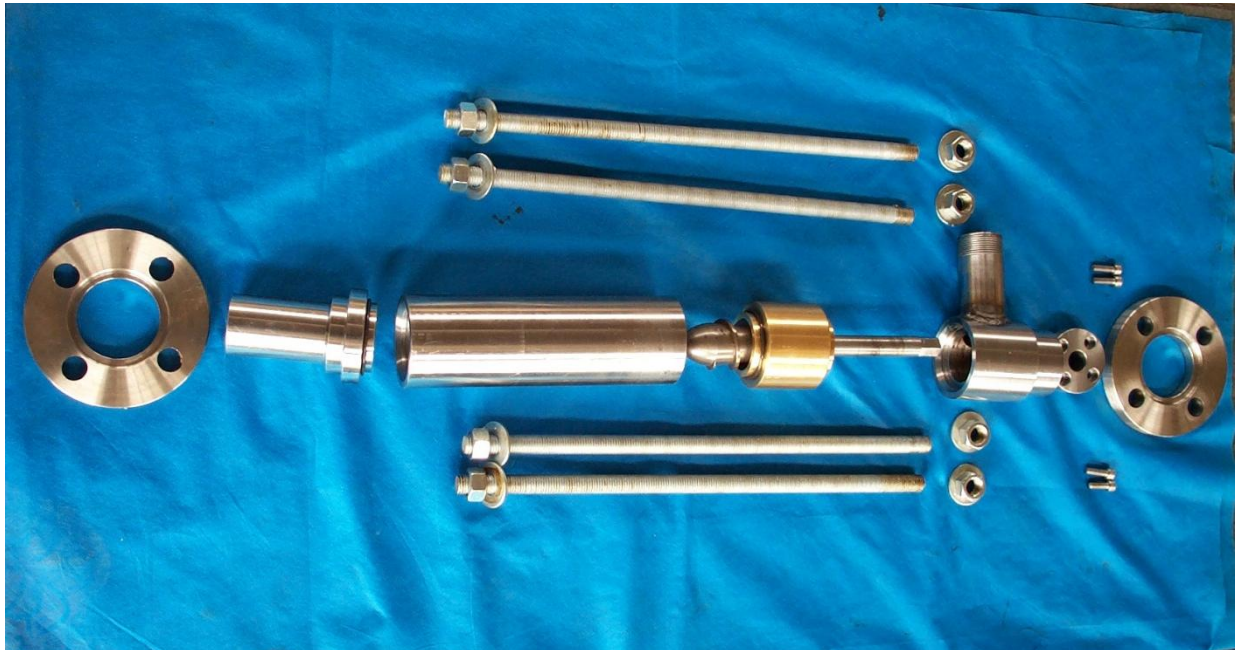
Figura 5-14 - Fotos da nova Válvula Ciclônica de Escoamento Direto, identificada como VCED3
