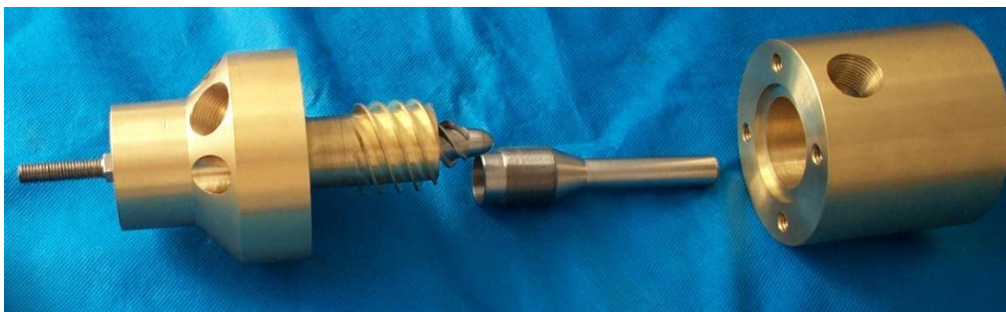
Figura 3-8 – Válvula ciclônica de escoamento reverso – detalhe das hélices de entrada e de saída.
