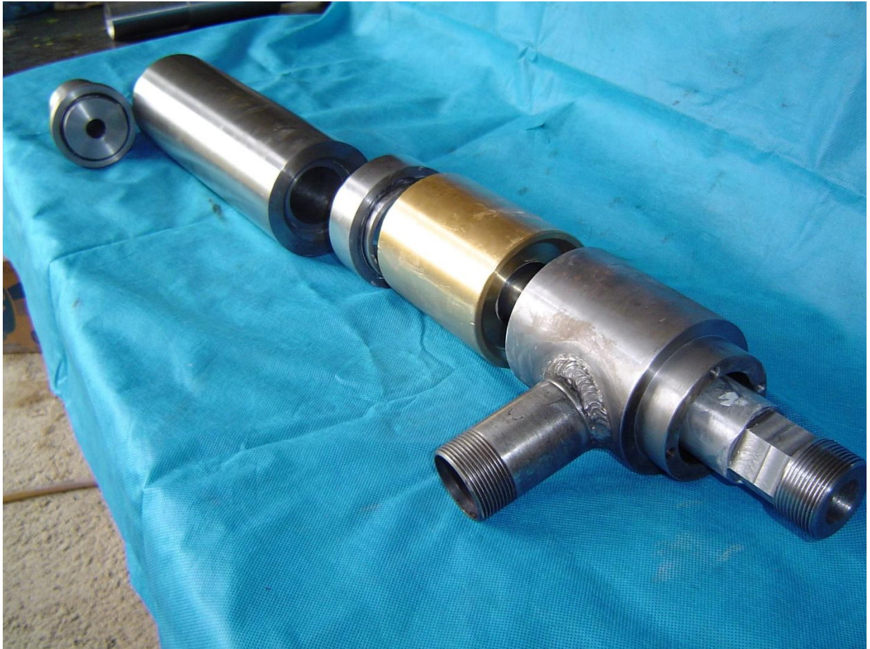
Figura 5-17 - Fotos da nova Válvula Ciclônica de Escoamento Direto, identificada como VCED3 e no detalhe o obturador desta válvula
