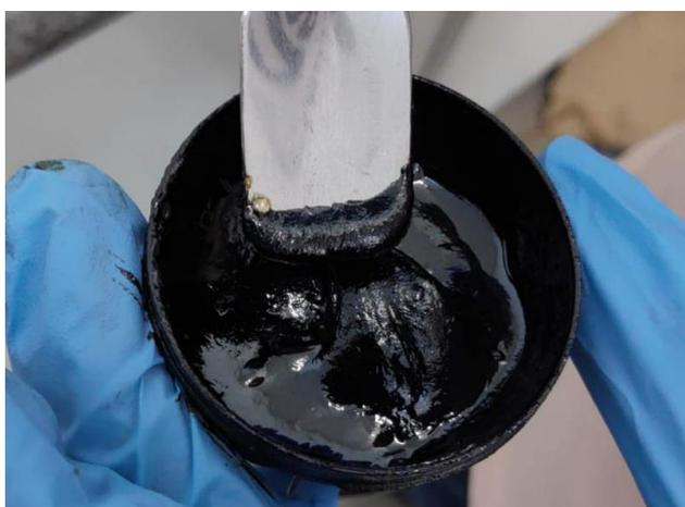
Figura 3.1. Amostra de borra oleosa de petróleo de fundo de tanque de óleo combustível
