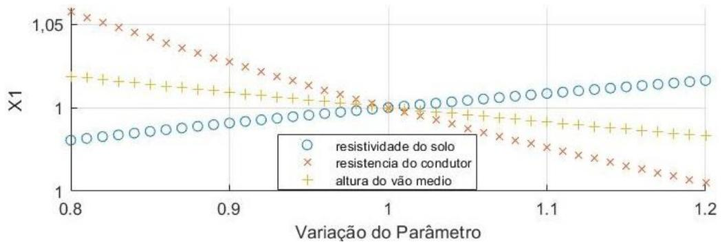
Figura 21 - Sensibilidade do parâmetro concentrado X1 frente as variações na resistividade do solo, resistência do condutor e altura do vão médio.
