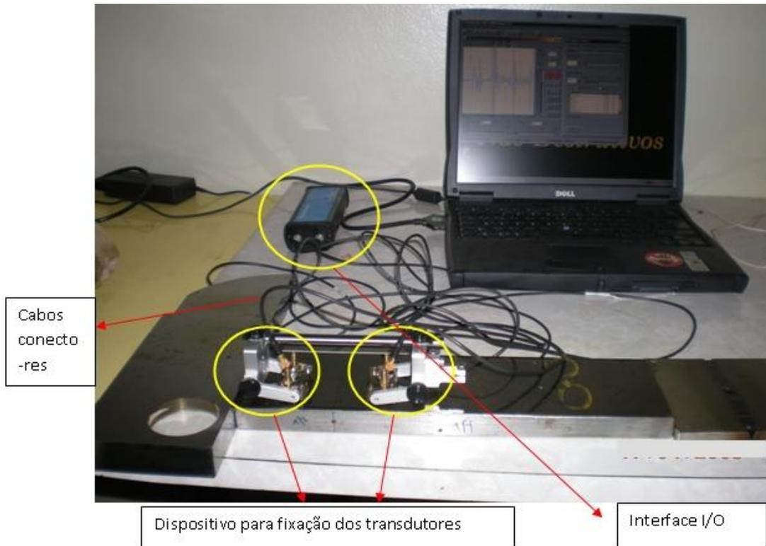
Figura 3.1: Banco de testes utilizando TOFD.
