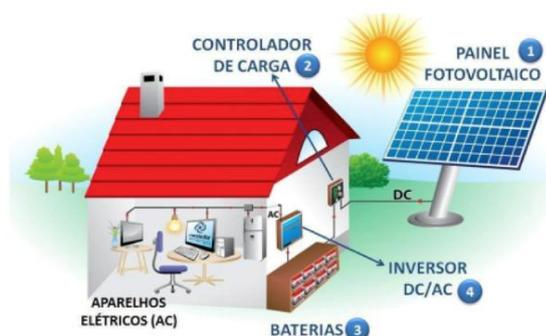
Figura 8 – Sistema Off Grid
