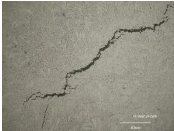
Figura 4 – Ataque de hidrogênio em alta temperatura.
