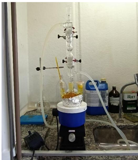
**Figura 8** - Aparato experimental para a síntese dos complexos metálicos CuCUR e ZnCUR.
