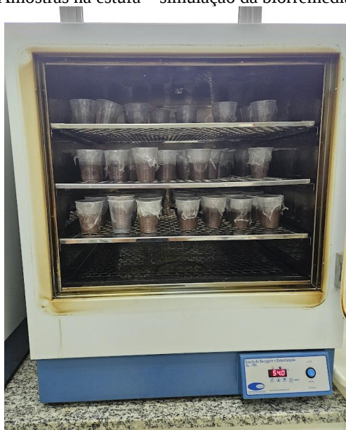
Figura 6 – Amostras na estufa – simulação da biorremediação térmica
