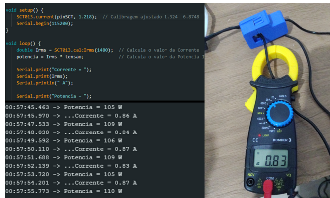
Figura 23 – Comparação entre valores reais e os obtidos pelo SCT-013 após calibração
