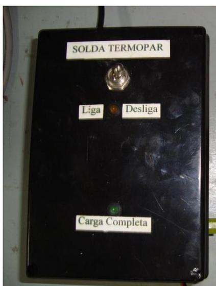
Figura 4.8 – Descarga Capacitiva.
