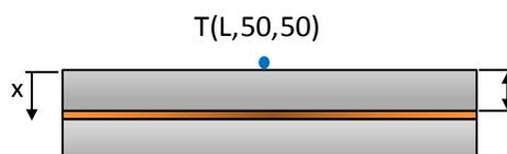
Figura 4.15 – Posição do termopar na amostra.
