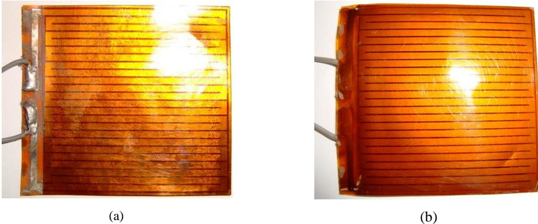
Figura 4.4 – Aquecedor Resistivo: (a) vista superior e (b) vista inferior.
