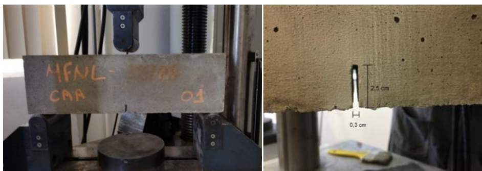
Figura 1: Ensaio de modelo reduzido de viga em concreto simples convencional
