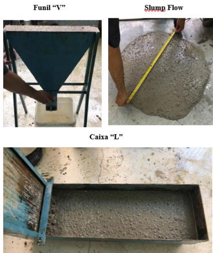
Figura 29: Ensaios concreto estado fresco para CAA.
