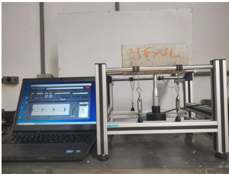
Figura 30: Aparelho Sonelastic®, módulo de elasticidade dinâmico.
