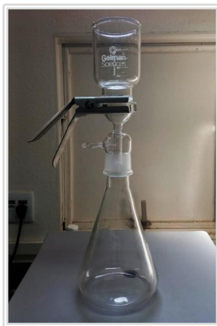
Figura 8 – Aparato Experimental Utilizado na Filtração.
