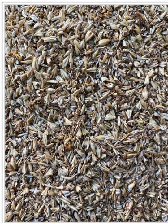
Figura 5 – Bagaço de Malte Após as Etapas de Secagem, Preparado para ser Utilizado nos Estudos de Caracterização.
