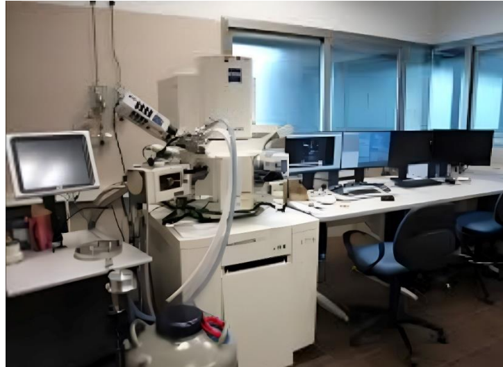
Figura 16. Microscópio de emissão de campo, GeminiSEM 500 de alta resolução.
