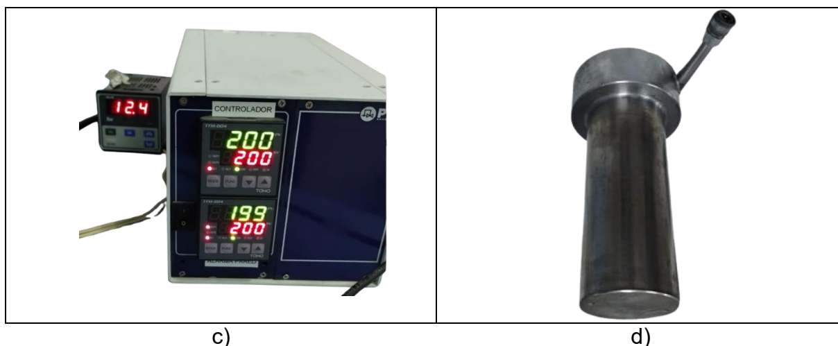
Figura 13. Autoclave de aço inoxidável Burton-Corblin. a) Vista frontal, b) vista lateral, c) controlador remoto de temperatura e pressão, d) vaso de aço inox de capacidade de 1 litro.
