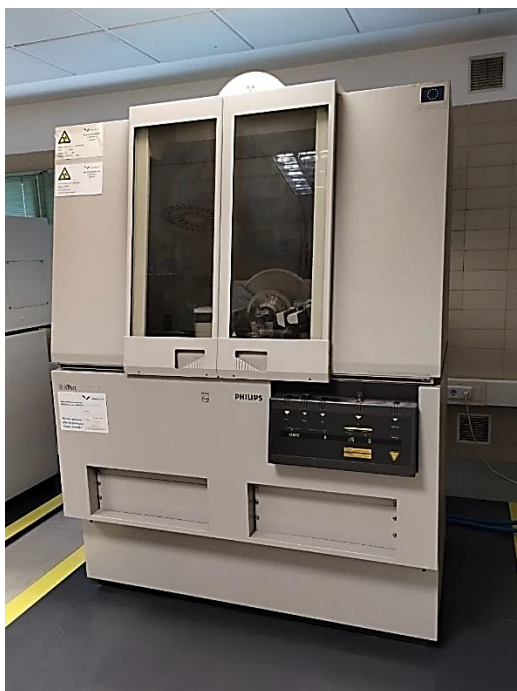
Figura 15. Difratorômetro de raios X, marca Philips modelo X'Pert MPD. Equipamento localizado no IRICA - UCLM.
