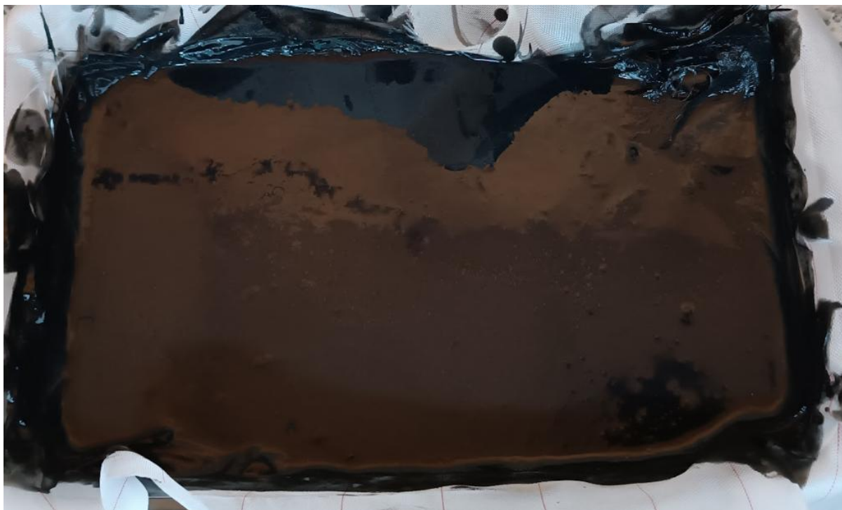
Figura 38 - Resultado do método de submersão de fibra em acetona diluída Fonte: Autor (2025)
