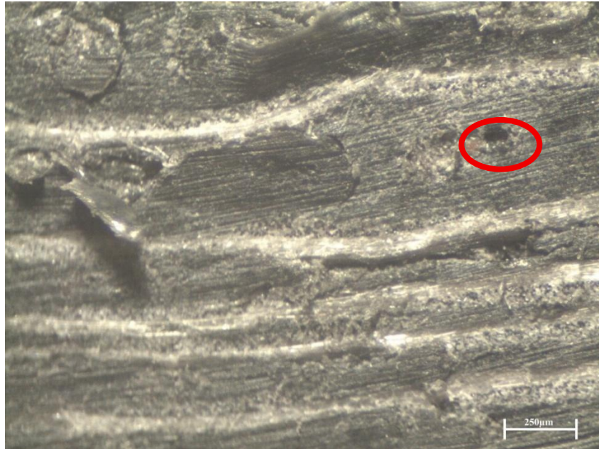
Figura 44 - Ampliação do corpo de prova mostrando pequenas porosidades e as fibras em detalhe. Fonte: Autor (2025)
