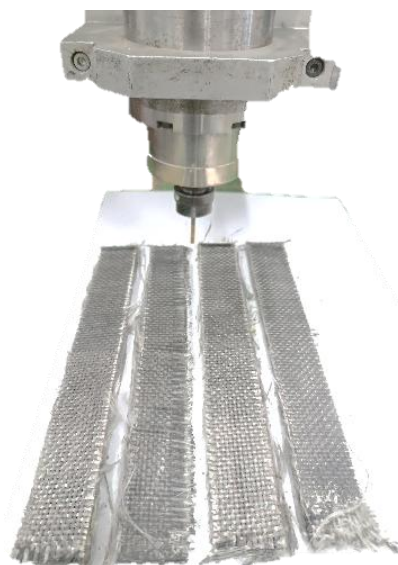
Figura 26 - Corte dos corpos de prova por usinagem. Fonte: Autor (2025)
