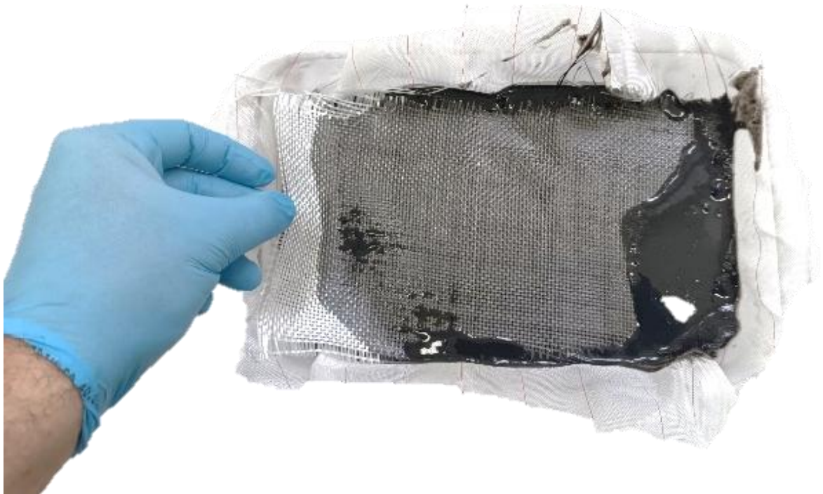
Figura 24 - Deposição de manta de fibra em ABS diluído em acetona. Fonte: Autor (2025)
