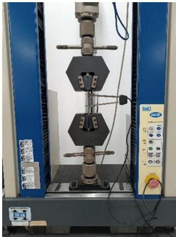
Figura 27 - EMIC DL3000 ensaiando corpo de prova Fonte: Autor (2025)
