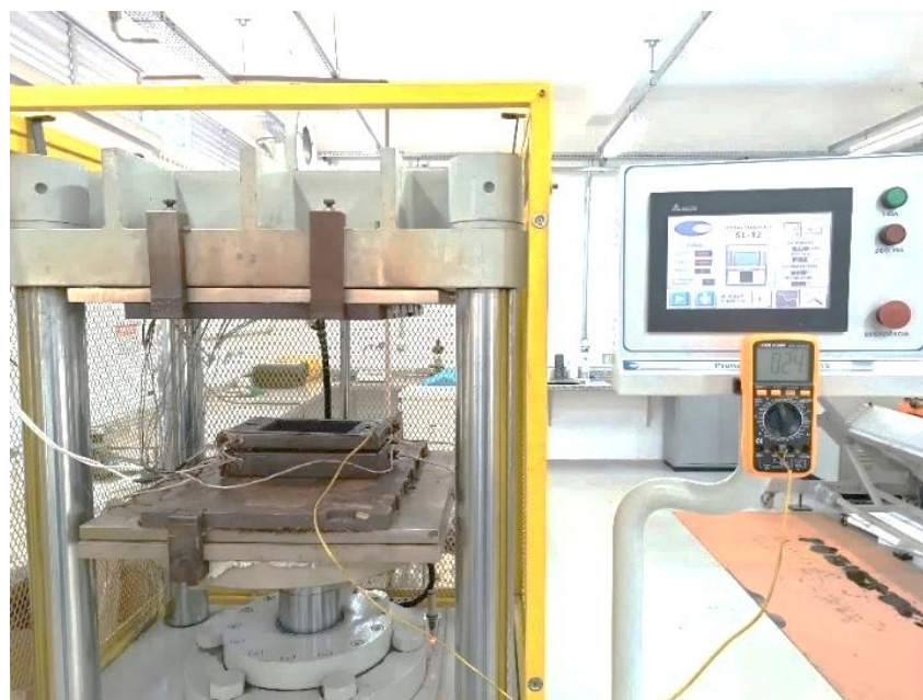
Figura 22 - Molde metálico montado na prensa hidráulica. Fonte: Autor (2025)
