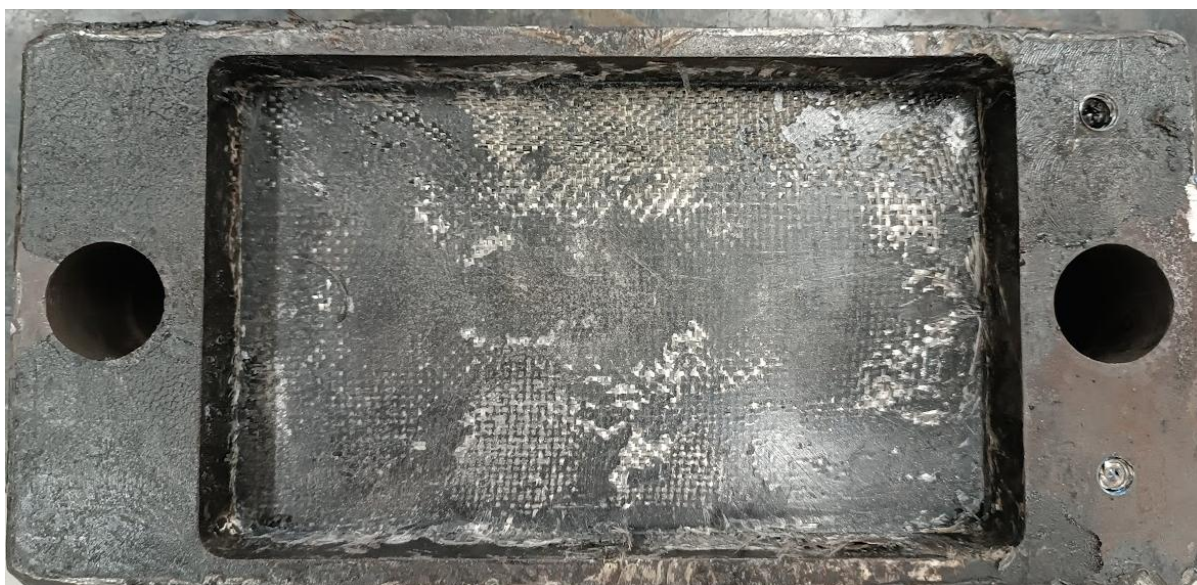
Figura 37 - Resultado da consolidação por pressão e temperatura Fonte: Autor (2025)
