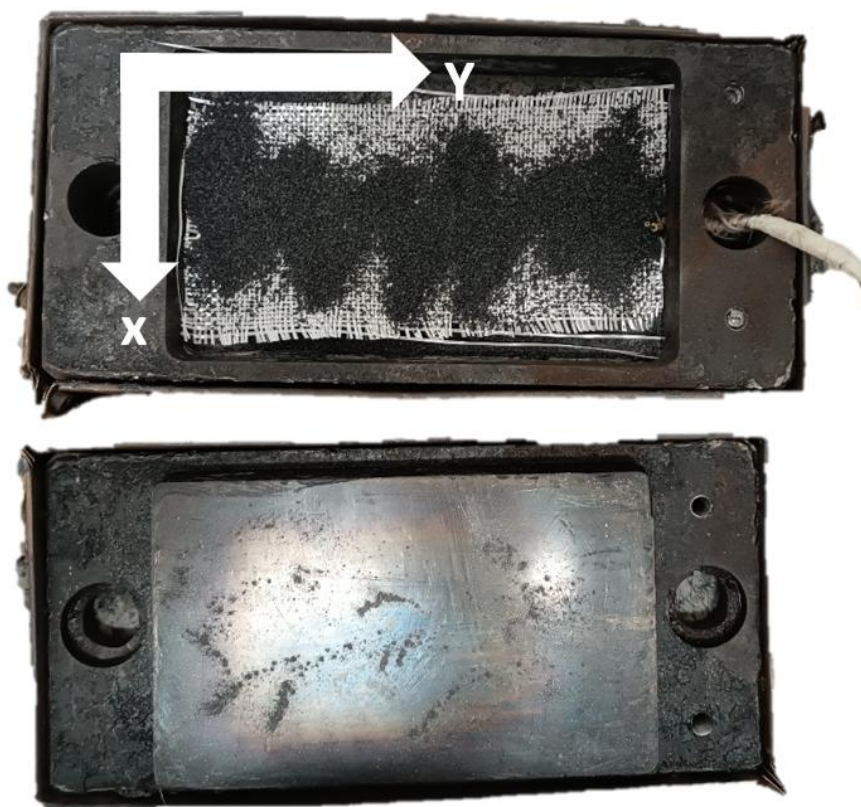
Figura 23 - Matriz montada com camadas de fibra e ABS particulado entre cada camada, já com termopar no interior e resistência elétrica em torno. Fonte: Autor (2025)
