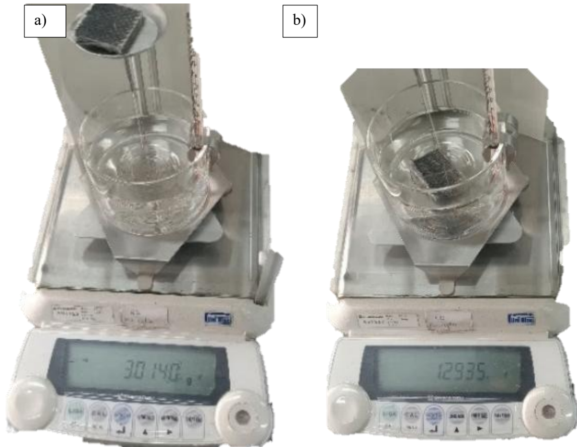
Figura 29 - Ensaio de densidade por princípio de Arquimedes. a) massa seca. b) massa molhada. Fonte: Autor (2025)
