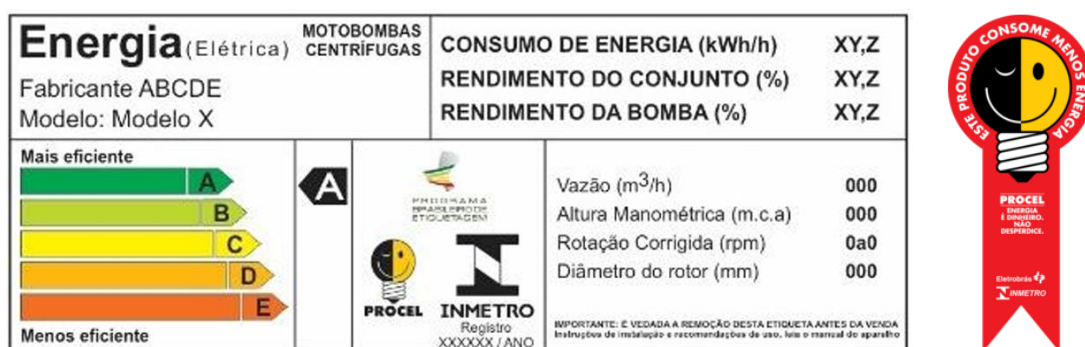
Figura 2.5 - Etiqueta de eficiência energética (bomba centrífuga) e Selo Procel
