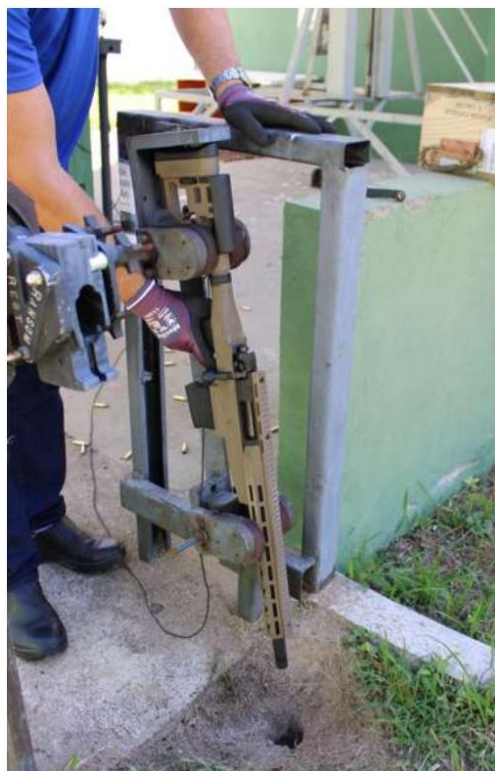
Figura 38 - Posicionamento do fuzil para teste a -80^\circ
