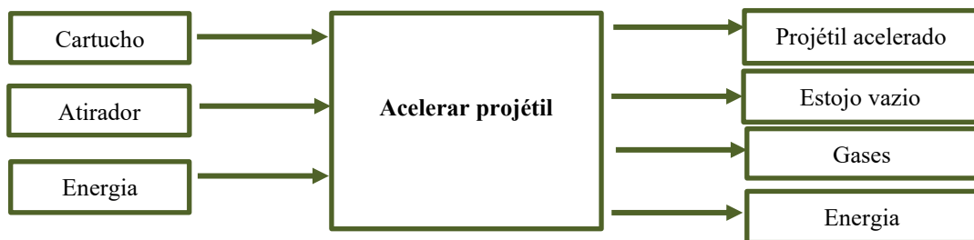
Figura 26 – Exemplo de diagrama função total do fuzil de alta precisão Fonte: Adaptado de Almeida Filho e Rocha (2021)
