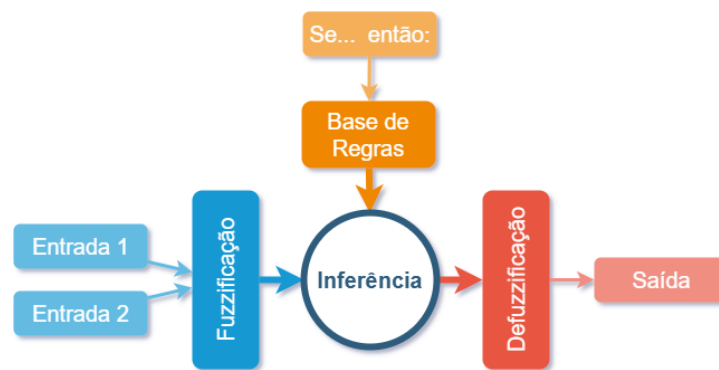
Figura 11 – Diagrama exemplo de um sistema de inferência Fuzzy (SIF) com duas variáveis de entrada e uma de saída.
