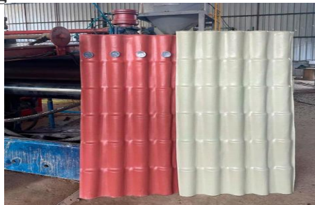
Figura 22 - Telhas de PEAD com Grafeno
