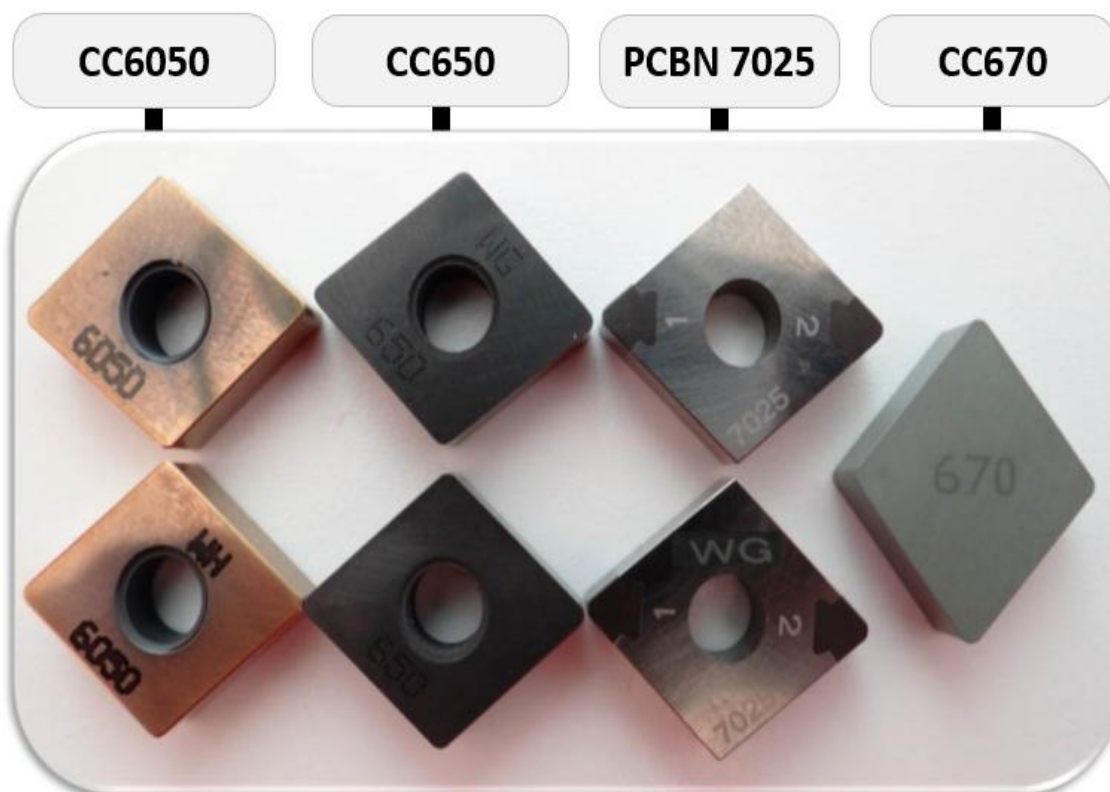
Figura 14: Amostra das sete pastilhas utilizadas no torneamento do aço AISI H13 endurecido
