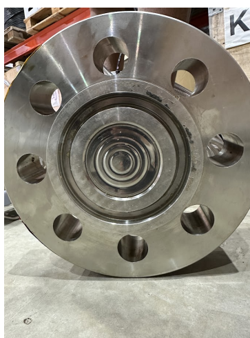
Figura 54 – Membrana do medidor de pressão diferencial PDT001
