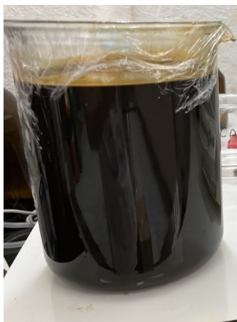
Figura 17 – Amostra de petróleo homogenizado e aquecido do tanque TQ-3.
