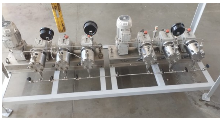
Figura 63 – Bombas de diafragma para bombeio de petróleo e de CO 2 .
