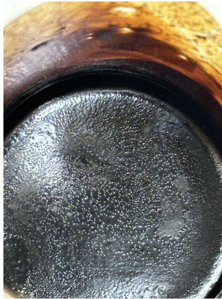
Figura 108 – Depósito do teste a 96,6 barg com CO 2 durante a solidificação, com desprendimento de bolhas de gás.
