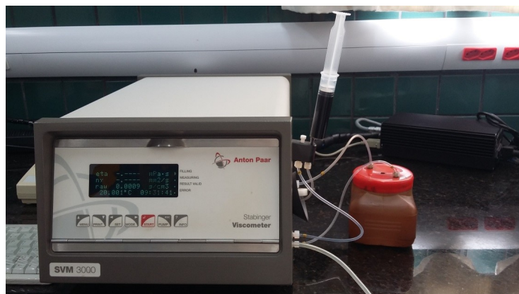
Figura 19 – Viscosímetro Anton Paar SVM 3000 do NUSEC.
