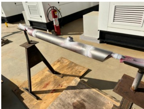
Figura 64 – Vaso separador petróleo-gás do loop experimental de alta pressão em fabricação.
