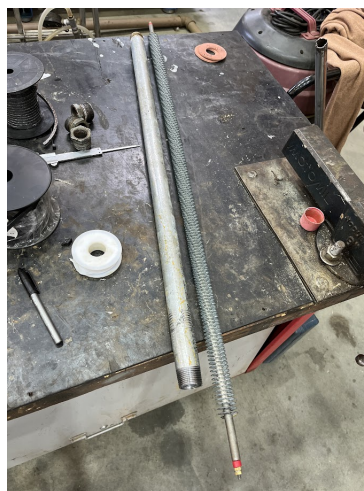
Figura 42 – Detalhes do aquecedor tubular utilizado para aquecimento do ar comprimido.
