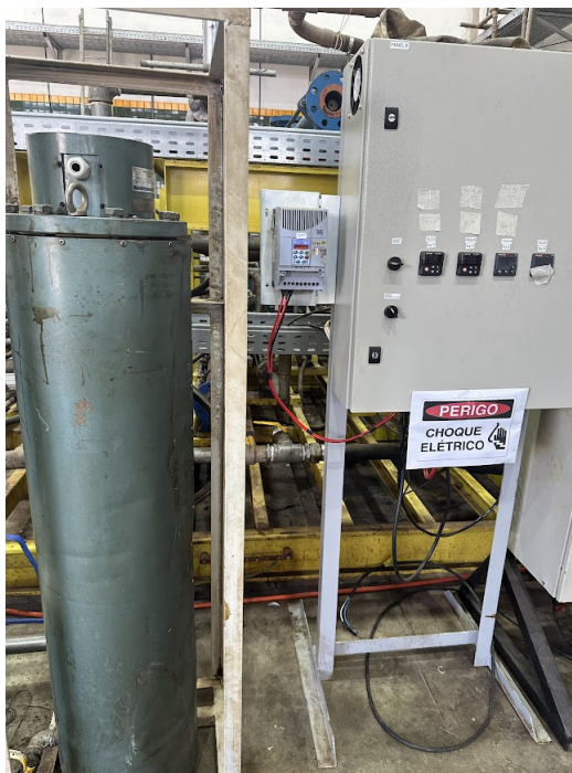
Figura 33 – Aquecedor elétrico de petróleo da UNIFEI-NUSEC.
