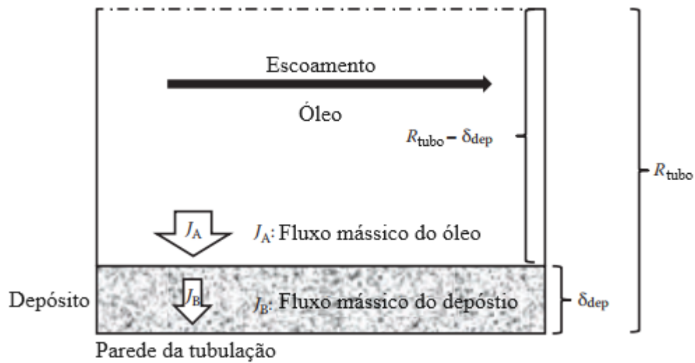
Figura 9 – Esboço esquemático dos fluxos mássicos das parafinas em um tubo.
