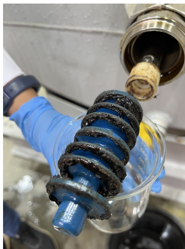
Figura 58 – Pig para remoção do depósito no tubo.
