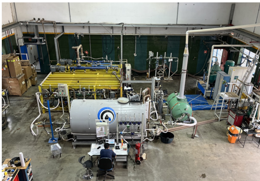
Figura 49 – loop de deposição bifásico de parafinas do NUSEC.
