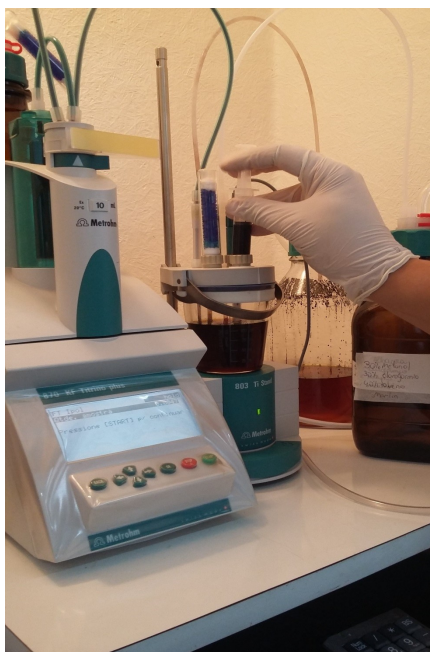
Figura 20 – Titulador digital de reagente de Karl-Fischer marca Metrohm, modelo Titrino Plus 870 do NUSEC.
