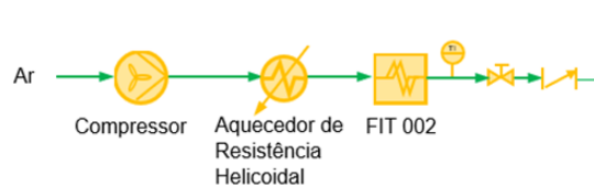
Figura 40 – Linha de ar quente do PFD do loop.
