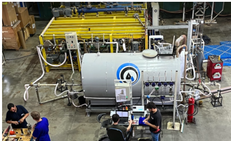
Figura 27 – loop experimental de baixa pressão do NUSEC na configuração monofásica.
