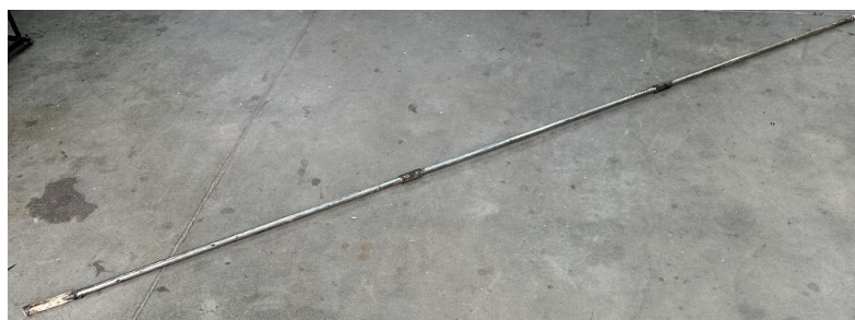
Figura 59 – Haste de passagem de pig .
