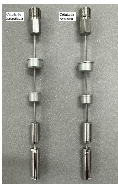
Figura 23 – Células para análise em alta pressão do Microcalorímetro digital Setaram Micro DSC IIV Evo do CTPB.
