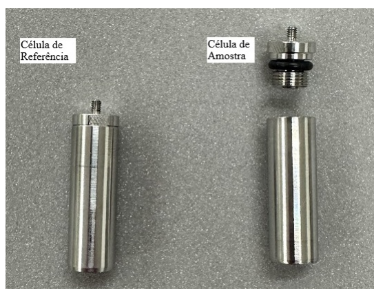
Figura 22 – Células para análise em baixa pressão do Microcalorímetro digital Setaram Micro DSC IIV Evo do CTPB.
