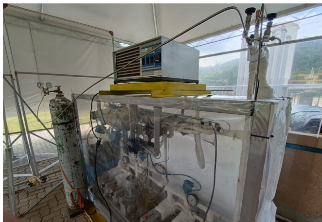
Figura 66 – Banho termostático para resfriamento e circulação de água gelada do HP loop e isolamento das linhas.
