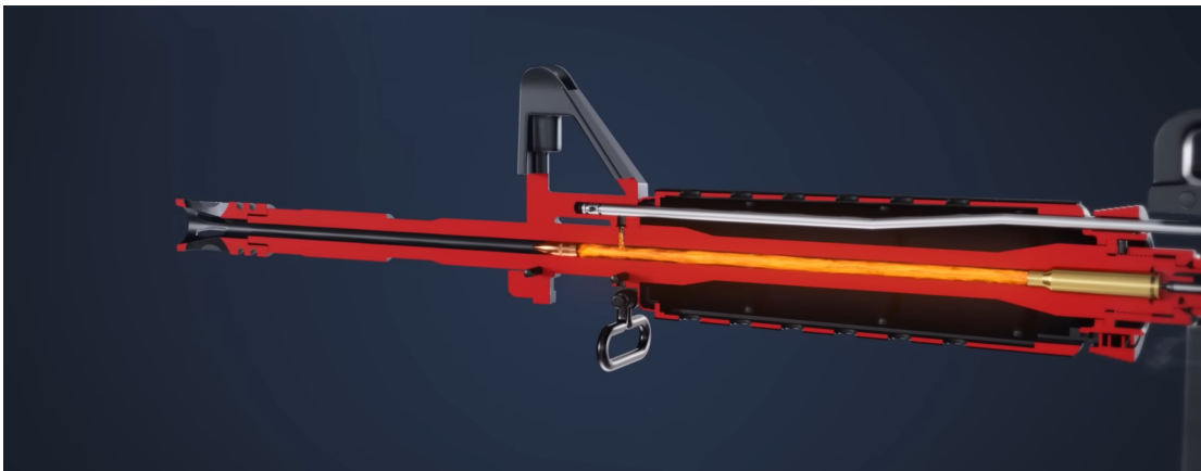
Figura 2.3 – Sistema de automatismo do fuzil AR-15. Fonte: (RITTMAN, 2025).
