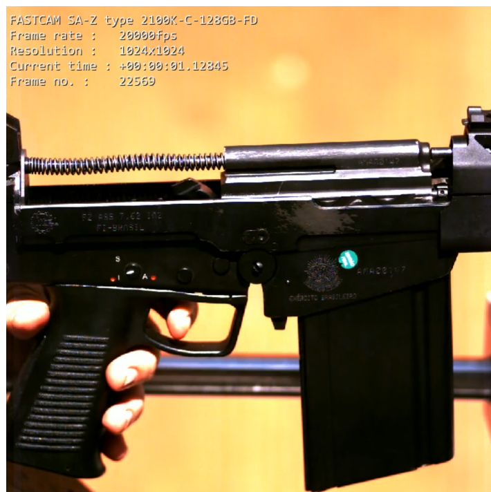
Figura 4.4 – Quadro da filmagem em câmera lenta da dinâmica do impulsor do ferrolho.
