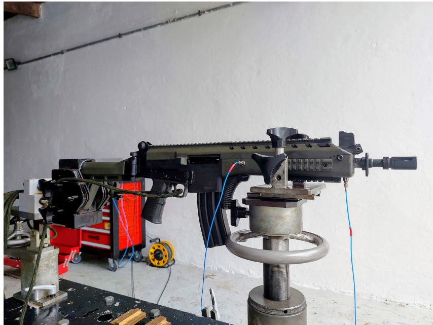
Figura 4.1 – Fuzil instrumentado com os transdutores de pressão.
