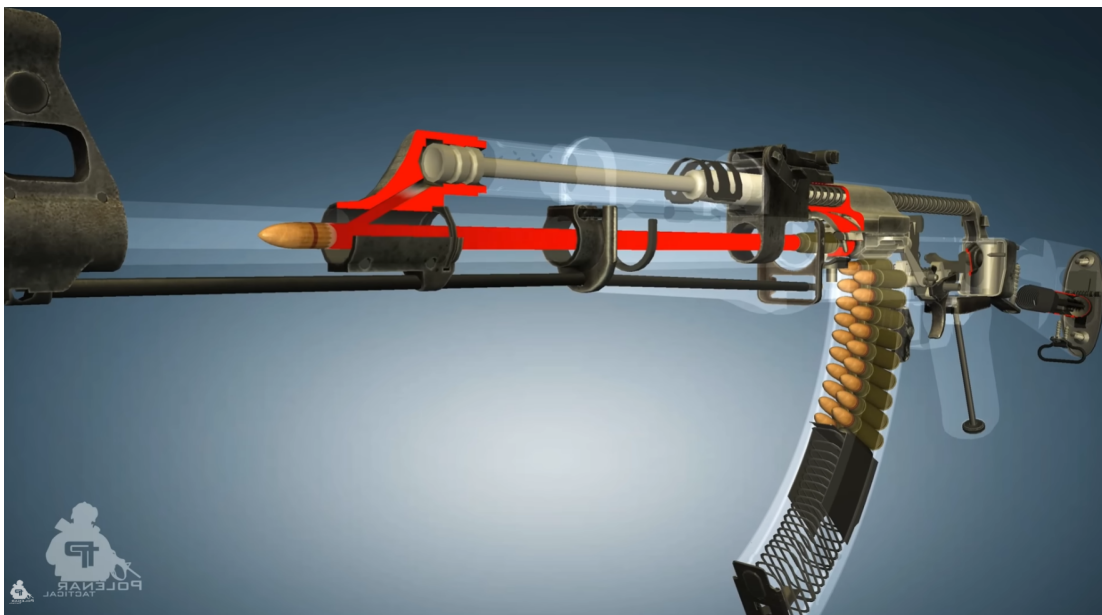
Figura 2.2 – Sistema de automatismo do fuzil AK-47. Fonte: (GUNS, 2025).
