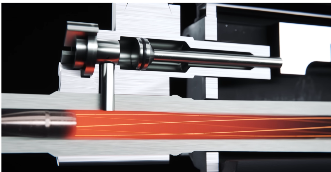
Figura 2.5 – Sistema de automatismo do fuzil SCAR-H. Fonte: (PACEM, 2025).
