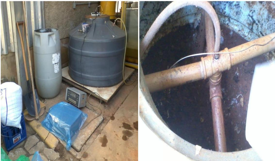
**Figura 12:** a) Balança utilizada para a determinação da massa de cada tipo de resíduo (esquerda); b) Início do processo de montagem – camada de argila de fundo (direita).
