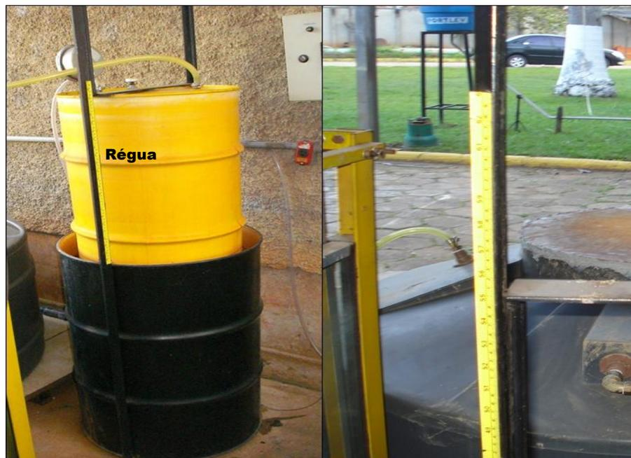
**Figura 14:** Régua na lateral do gasômetro
