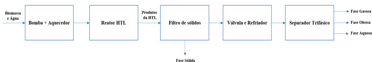
Figura 04 - Diagrama de blocos do processo de HTL. Fonte: Autoria própria, 2025.
