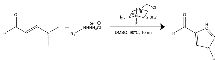
Figura 9: Síntese de pirazóis utilizando enaminonas e cloridratos de hidrazina.
