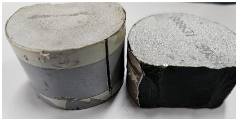
Figura 40. Varistores de ZnO de amostras de para-raios.
