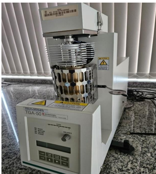
Figura 48. Analisador termogravimétrico para análise de TGA das amostras.
