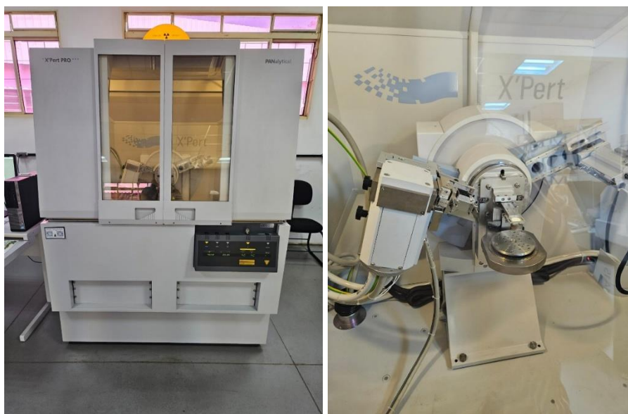
Figura 55. Difratômetro para análise das estruturas cristalinas das amostras.
