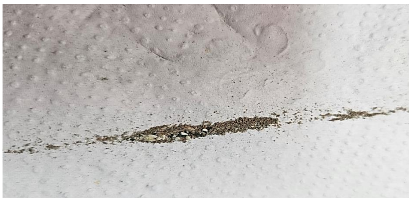
Figura 41. Fragmentos do varistor para ensaios de TGA e DSC.
