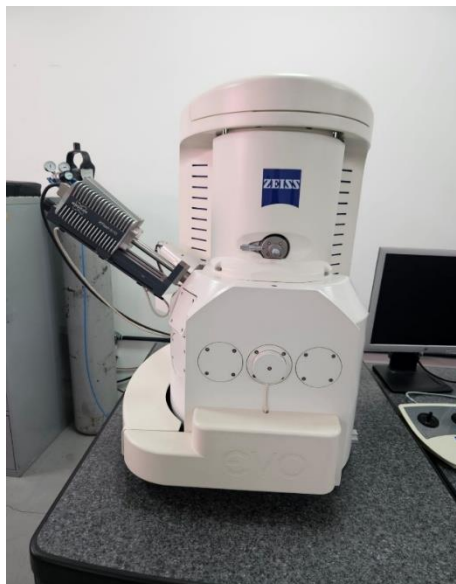
Figura 53. Microscópio eletrônico de varredura com espectrômetro acoplado para análise por MEV e EDS.
