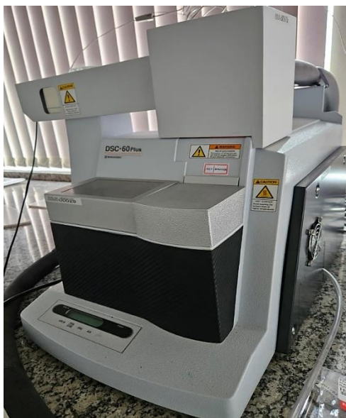
Figura 46. Calorímetro para análise de DSC das amostras.
