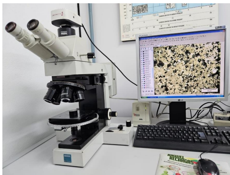
Figura 50. Microscópio ótico para análise microscópica das amostras.
